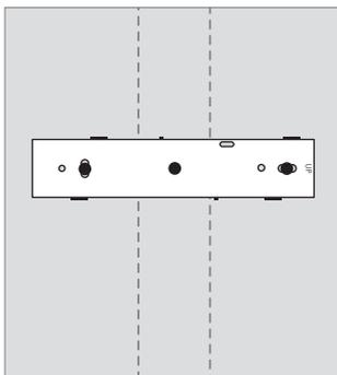
若是水平方向安裝，您必須使用三顆螺釘。個中兩顆同類型的螺釘透過孔 (E) 進入石膏板，另一顆方頭螺釘穿過托架中央的小孔。
